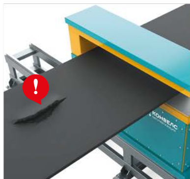
Расслоение поверхности ленты
