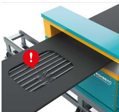
Повреждение и разрыв металлических тросов, в том числе коррозия
