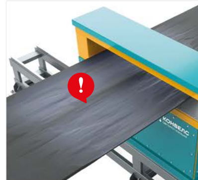
Преждевременный или чрезмерный износ покрытия ленты
