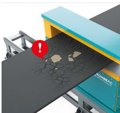
Трещины на поверхности ленты
