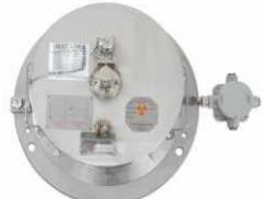
MOLA 7200A от Thermo Electron Corporation это надёжный высокотехнологичный датчик, использующий запатентованную импульсную ионизационную камеру нейтронного рассеяния для потокового измерения концентрации водородосодержащих материалов в промышленных бункерах.
