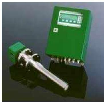
Системы анализа O<sub>2</sub>, CO в газах предназначены для измерения действительного содержания O<sub>2</sub>, CO в дымовом газе, образующемся при процессах горения, а также в других газах. Специальное циркониевое (ZrO<sub>2</sub>) покрытие сенсора позволяет увеличить срок службы, коррозионностойкость и устранить дрейф показаний. Также наличие пыли не влияет на качество измерения и срок службы сенсора.
